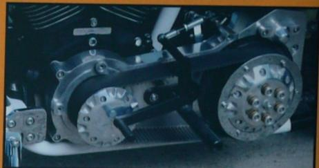
● Primárny prevod je riešený pomocou 2<sup>o</sup> remeňa a suchej spojky od firmy Ultima
